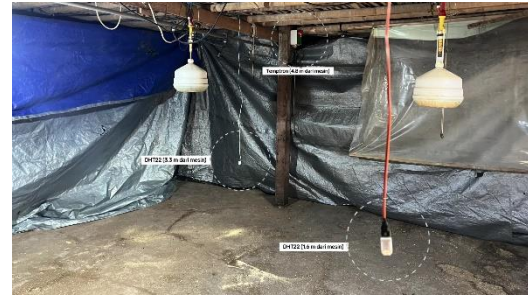
Gambar 11. Posisi Sensor DHT22 dan alat ukur temptron pada kandang ayam broiler
